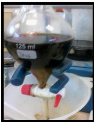
**Figura 11.** Proceso de separación del biodiesel y la glicerina producidos a partir del aceite de *F. resinosa*.
