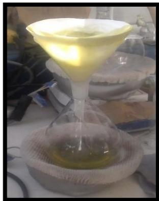
**Figura 9.** Proceso de filtración del aceite obtenido a partir de *R. communis*.
