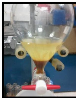
**Figura 12.** Proceso de separación del biodiesel y la glicerina producidos a partir del aceite de *R. communis*.
