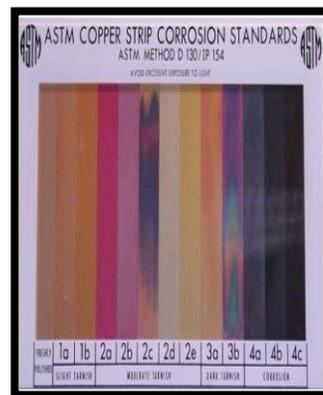
**Figura 14.** Placa patrón empleada para la prueba de corrosión.
