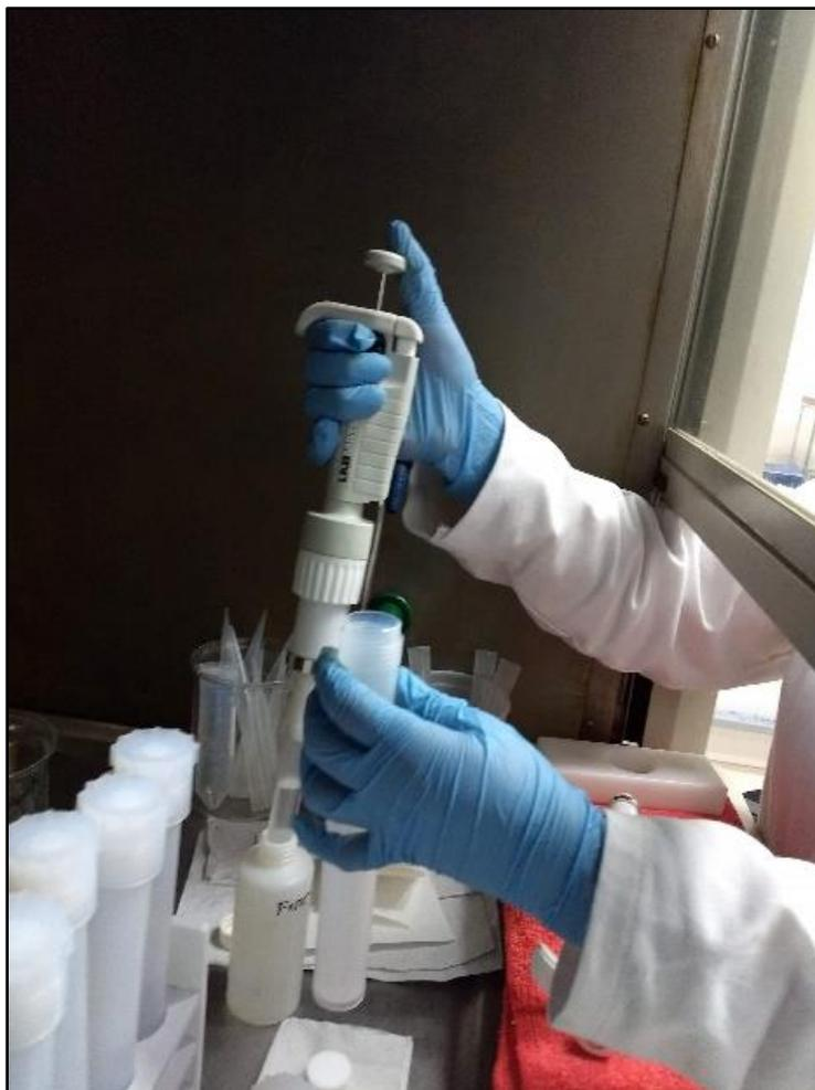
**Figura 7.** Preparación de muestra con  $\text{HNO}_3$
