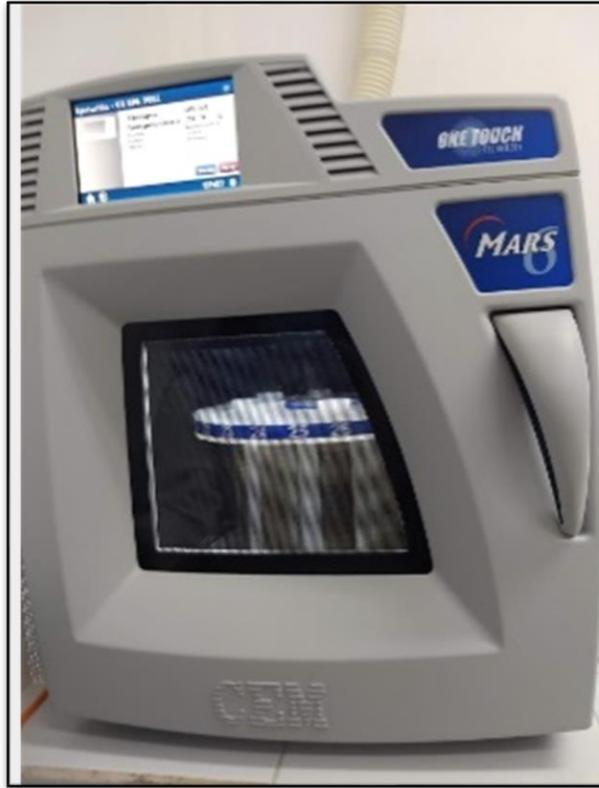
**Figura 8.** Digestión de muestras en el horno de microondas (CEM MARS 6).
