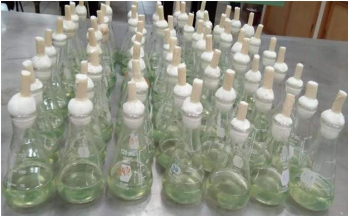
**Figura 5.** Matraces Erlenmeyer de 125 mL con 50 mL de medio GYE para fermentación sumergida (autoría propia).
