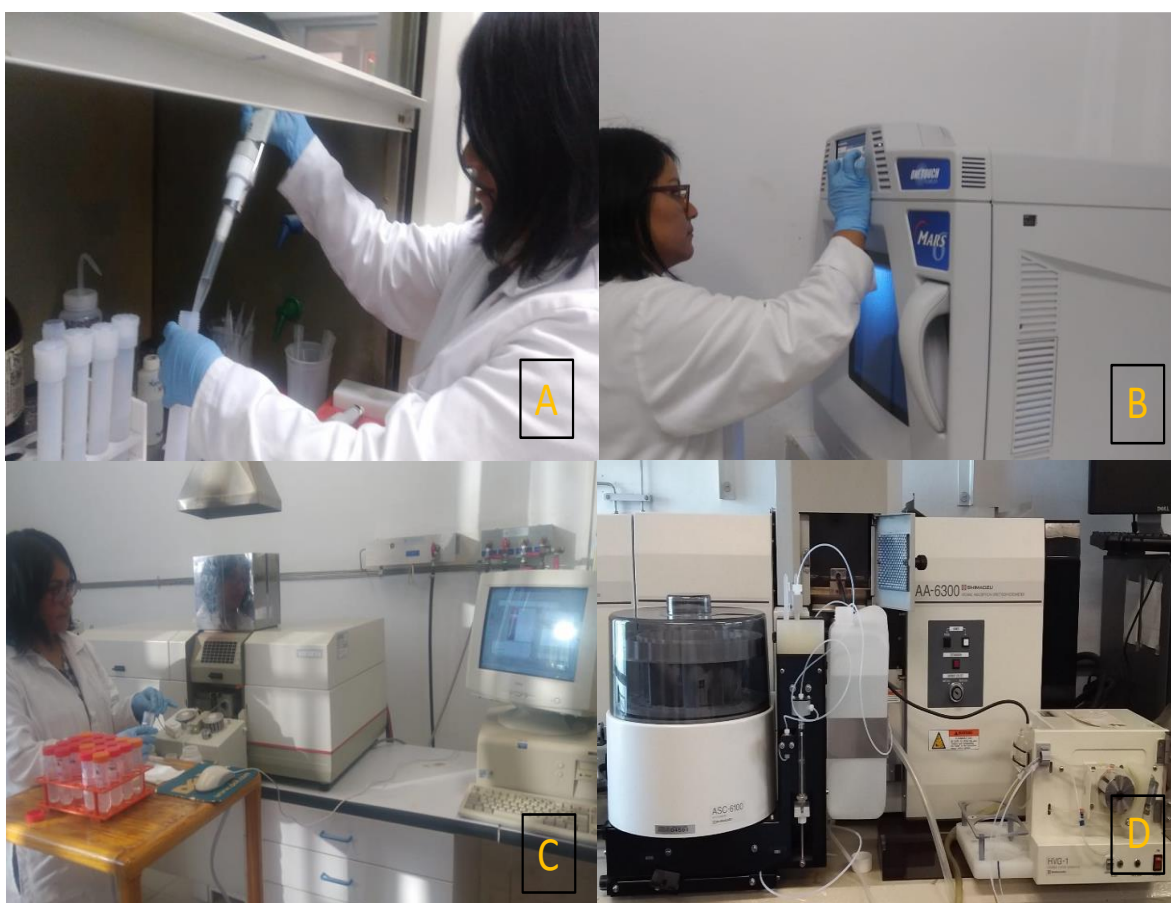
Figura 3. Digestión y análisis de muestras de agua. A y B) Digestión en microondas. C y D) Cuantificación por espectrometría de absorción atómica con detector de flama y generador de hidruros
