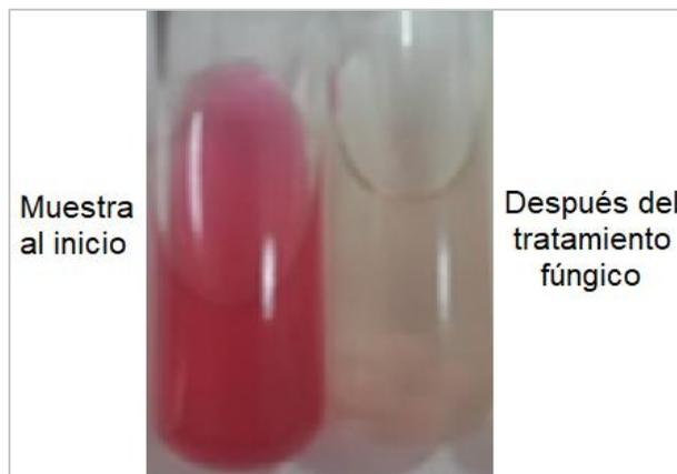
**Figura 5.** Ejemplo de degradación de colorante sintético. Degradación del colorante rojo ácido 88 por el hongo *Phanerochaete chrysosporium* (Deveci *et al.*, 2016).
