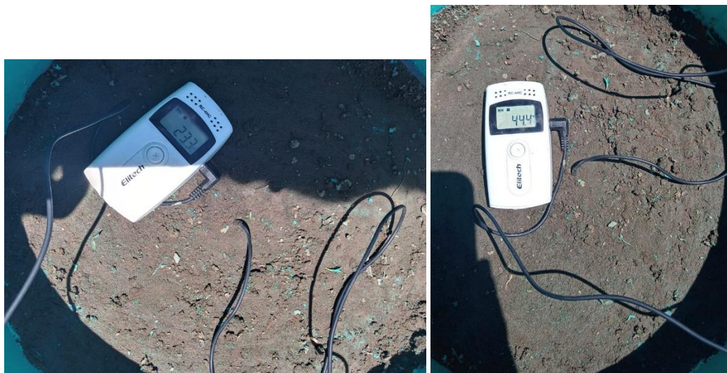
Figura 23. Medición de temperatura y humedad con equipo Hubb.
