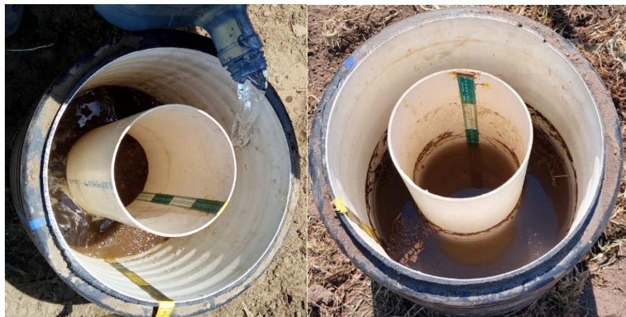
Figura 16. Medición de infiltración con infiltrómetro de doble anillo.
