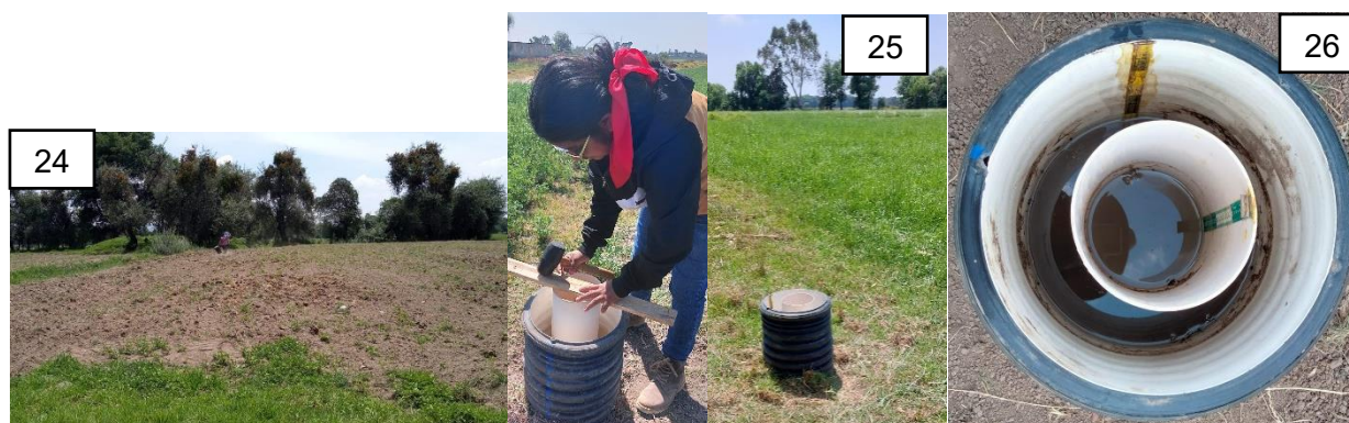
Figura 24. Parcela con obstáculo de árboles para la medición de infiltración. Figura 25. Proceso de hincar los anillos para la medición de infiltración. Figura 26. Obtención de las lecturas de infiltración.
