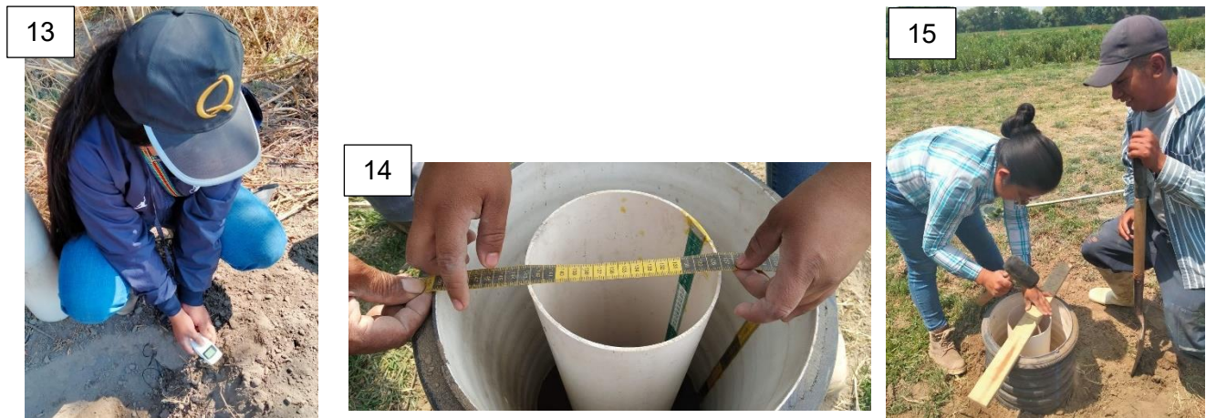
Figura 13. Registro de humedad y temperatura del suelo. Figura 14. Anillo interno colocado en el centro respecto al anillo externo. Figura 15. Anillos hincados.
