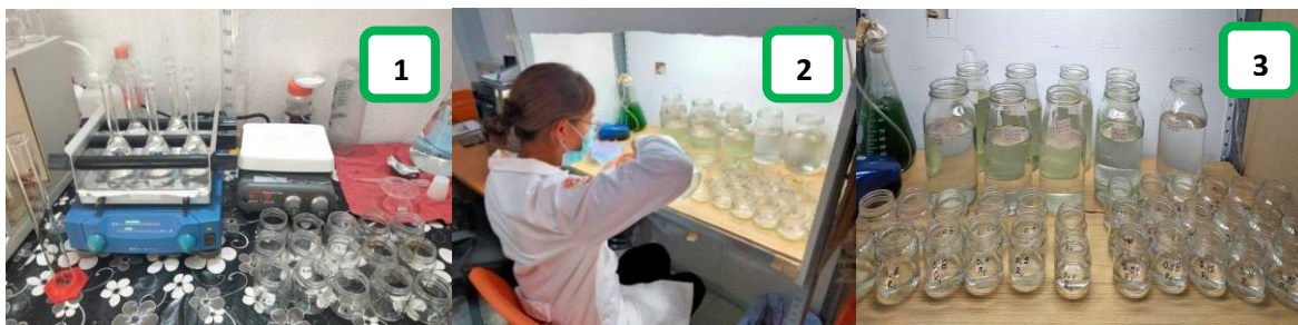
Figura 12. Prueba de toxicidad de NaClO (Cloralex® 3.5%) y antocianinas sobre D. magna . 1) en la figura se muestra la preparación del cultivo Chlorella vulgaris para la alimentación del organismo, 2) se clasifican los organismos 10 neonatos de la 3ra generación por frasco trabajando para la prueba de toxicidad y 3) en los frascos grandes se colocó D. magna grávidas por generación administrándoles su alimento y en los frascos pequeños se colocaron los neonatos con la muestra (NaClO y antocianinas) a evaluar la toxicidad.
