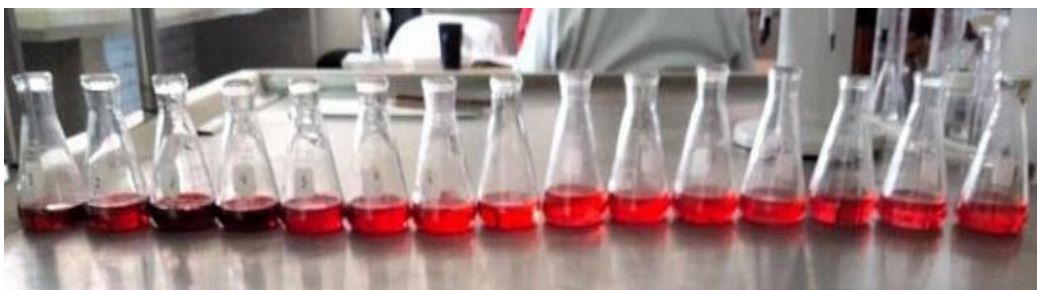
Figura 8. Tonalidades del extracto de la B. oleracea . Las fracciones coloridas se obtuvieron como resultado de una cromatografía en columna con Sephadex.
