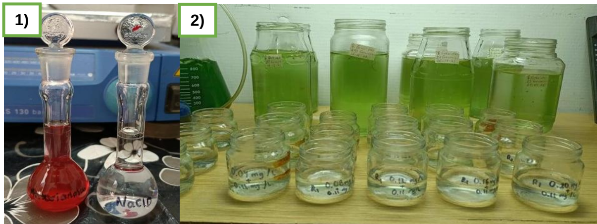
Figura 14. Prueba de toxicidad de soluciones de Cloralex + antocianinas sobre D. magna . 1) el matraz aforado de color rojo son las antocianinas de B. oleracea mientras que el otro matraz tiene la muestra acuosa de NaClO, 2) se muestra la prueba de toxicidad preparada para los resultados en 24 h.
