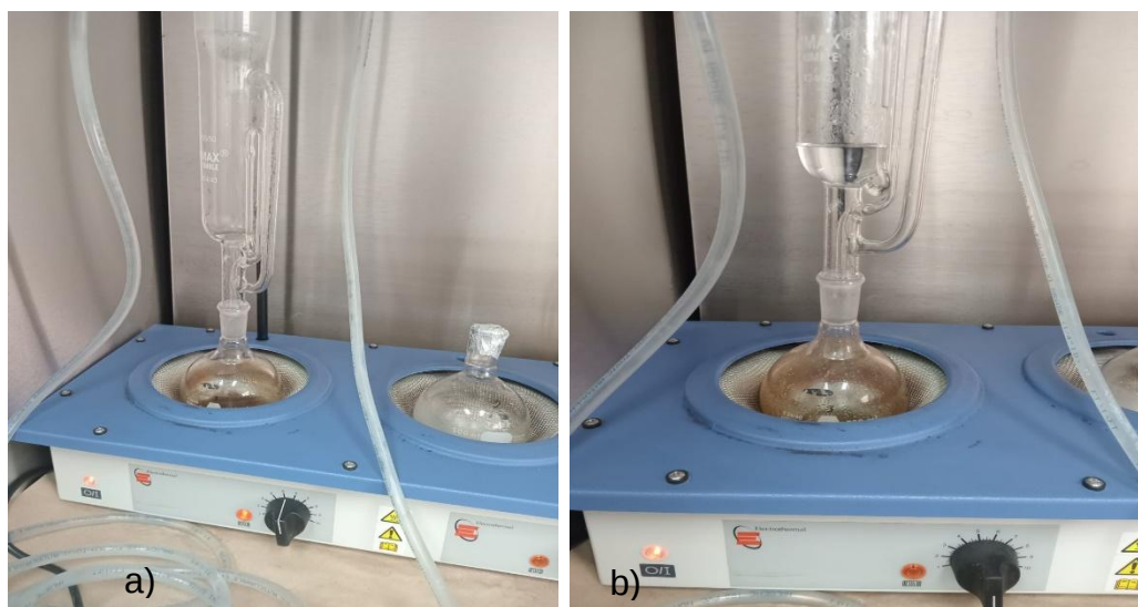
Figura 17. Destilación de nitrógeno total. a) Inicio de la destilación. b) Destilado recuperado.
