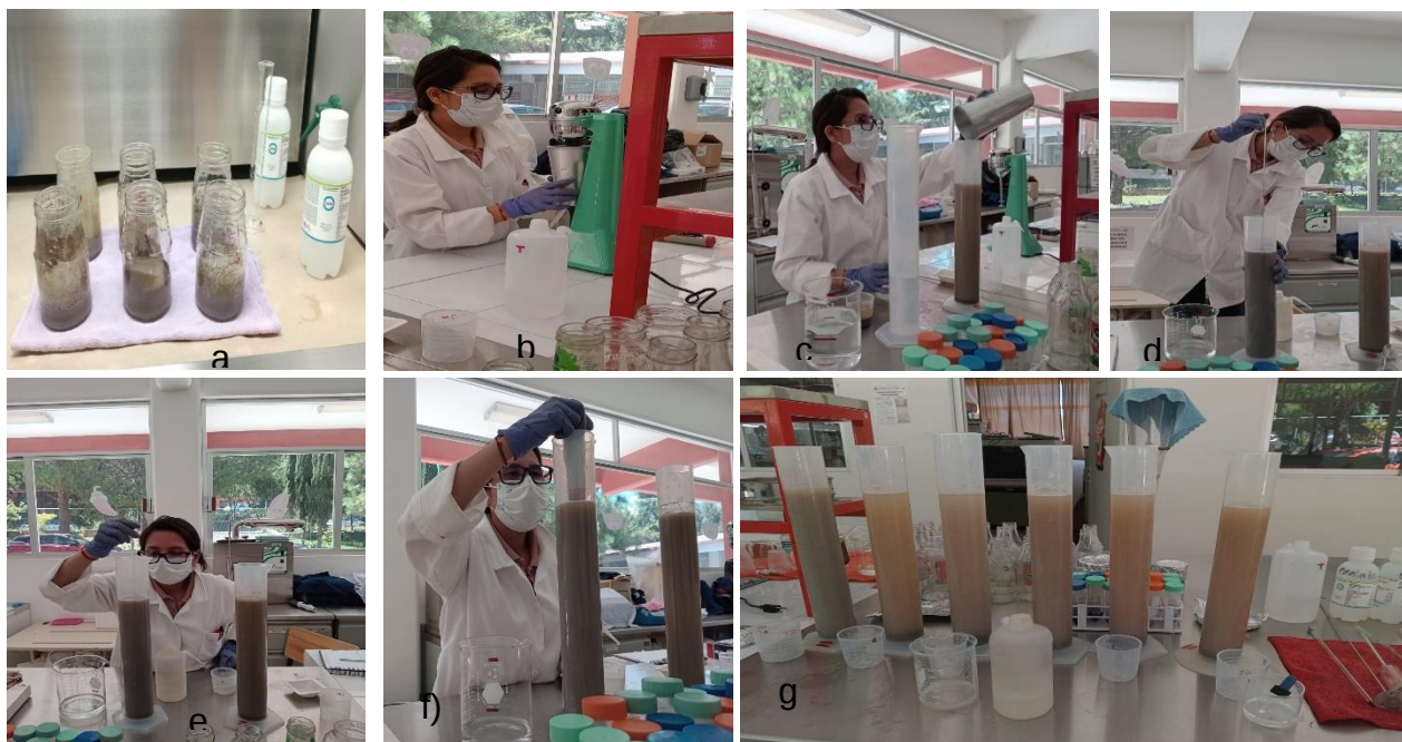
Figura 19. Determinación de Textura. a) Destrucción de materia orgánica. b) Agitación mecánica. c) Aforo de mezcla en probeta de 1000 mL. con hidrómetro dentro. d) Suspensión de mezcla con agitador manual. e) Toma de lectura con hidrómetro. f) Toma de pH y temperatura. g) Tiempo de reposo y segunda toma con el hidrómetro, pH y temperatura.
