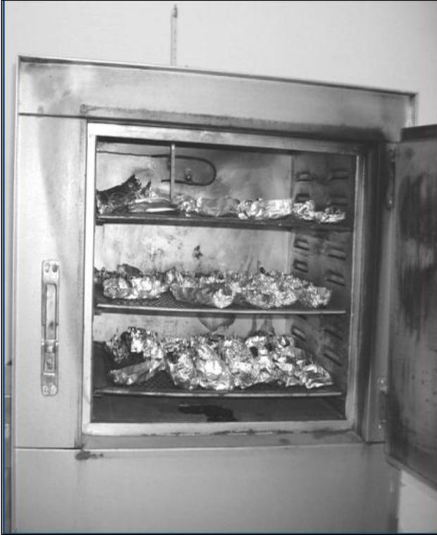
Figura 12. Muestras dentro del horno.
