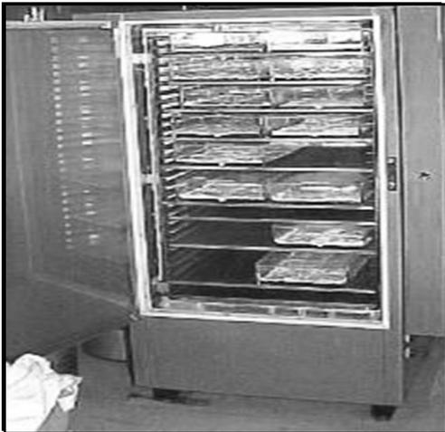
Figura 4. Cámara de incubación programada con 8 horas de oscuridad y 16 de luz y temperatura de 24 °C.
