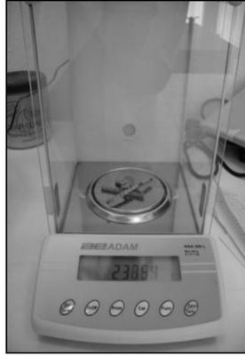
Figura 10. Obtención de peso saturado.
