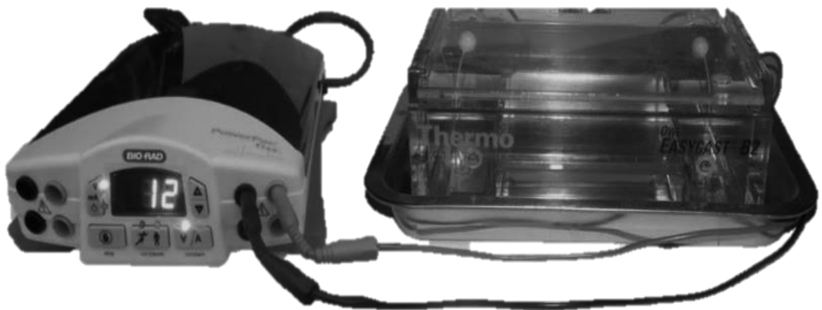
Figura 10. Sistema para desenrollamiento de molécula de ADN y electroforesis
