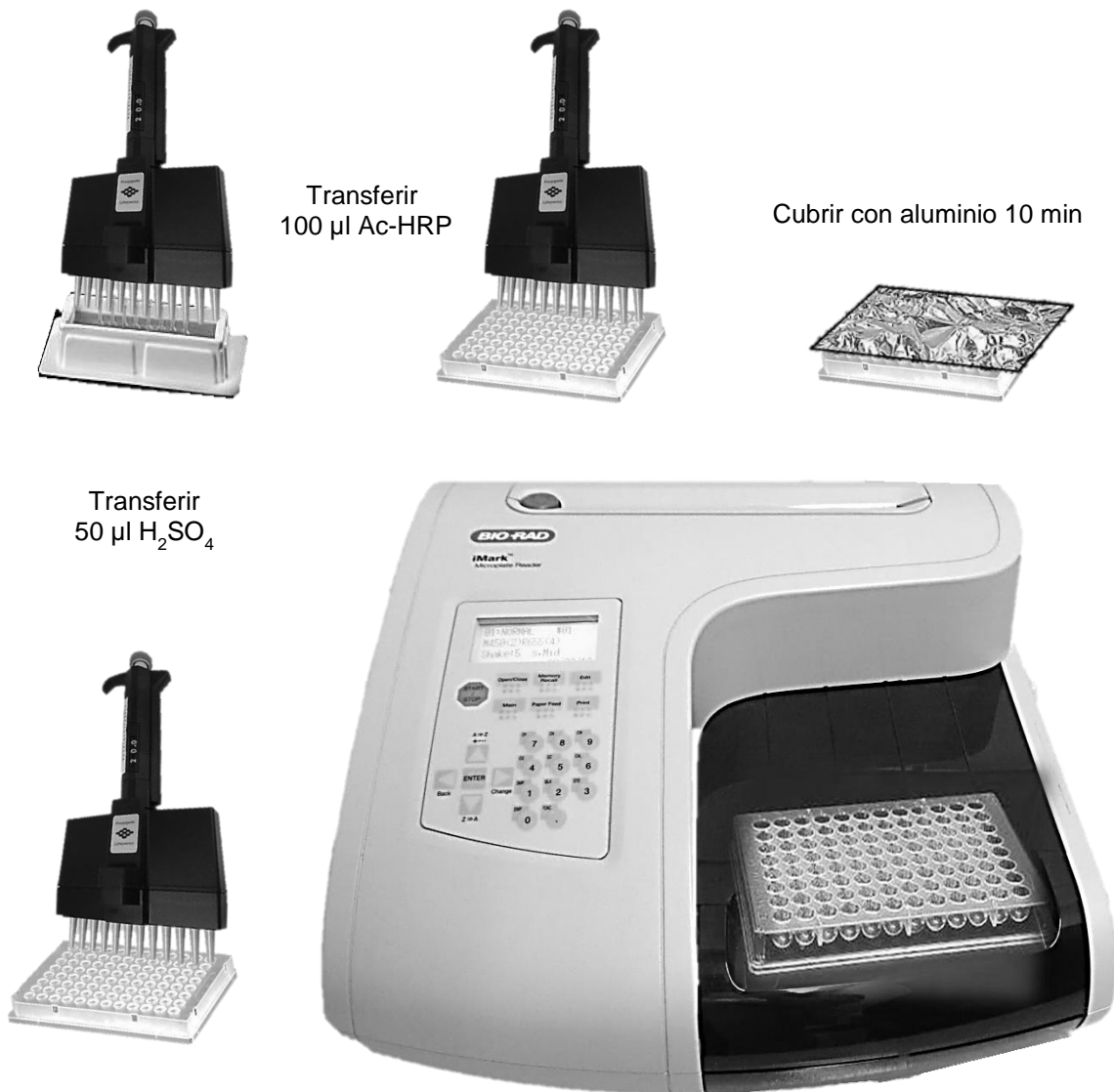
Figura 17. Adición del sustrato y lectura de la densidad óptica en el lector de microplaca
